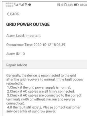
Figura 7-9 Información detallada de alarma de falla
